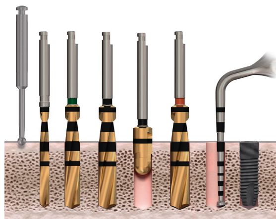
Направляющее сверло 2,0 (Twist Drill 2.0) Винтовое сверло 3,2 (Twist Drill 3.2) Винтовое сверло 3,7 (Twist Drill 3.7) Кортикальное сверло 3,7/4,0 (Twist Drill 3.85) Винтовое сверло 3,85 (Twist Drill 3.85) OsseoSpeed TX 4,0 S 13 мм (OsseoSpeed® TX 4.0 S, 13 мм)
