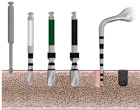
Направляющее сверло Guide Drill Винтовое сверло 2,0 (Twist Drill 2.0) Винтовое сверло 3,2 (Twist Drill 3.2) Винтовое сверло 3,7 (Twist Drill 3.7) OsseoSpeed TX 4,0 S 6 мм (OsseoSpeed® TX 4.0 S, 6 mm)
